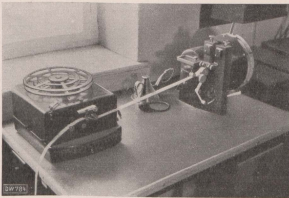
Bild 8. Registriergerät (Drehpulschnellschreiber) mit zwei Schreibfedern.
