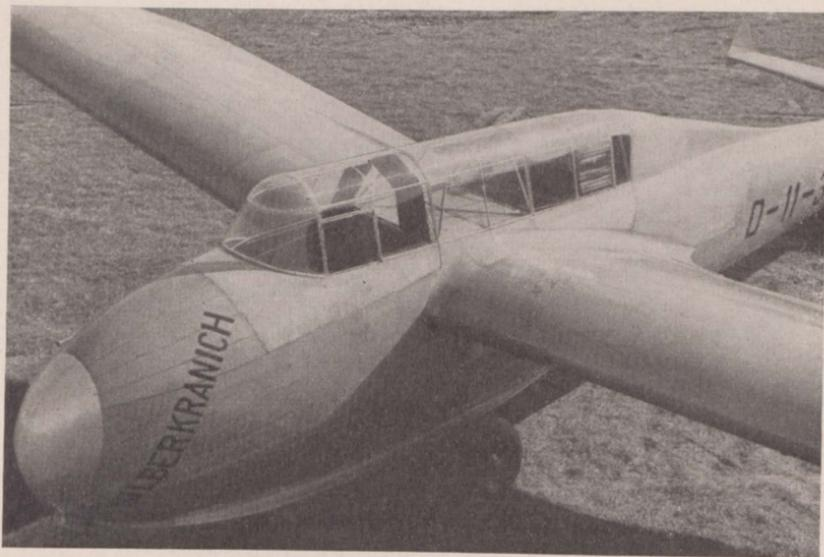
Bild 19. Doppelsitziges Segelflugzeug „Kranich“ mit geschlossener Führerhaube
