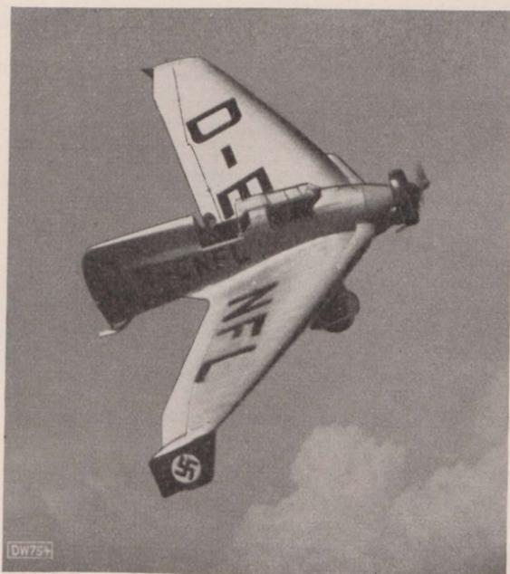
Bild 3. Nurflügel-Leichtflugzeug der DFS mit nach unten-außen hängenden gekielten Endscheiben als Seitenleitwerk
