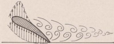
Bild 12. Jeder Tragflügel verliert bei einem bestimmten Anstellwinkel, der vom Profil abhängig ist, einen großen Teil seines Auftriebs, während der Widerstand stark wächst. Die Strömung „reißt ab“
