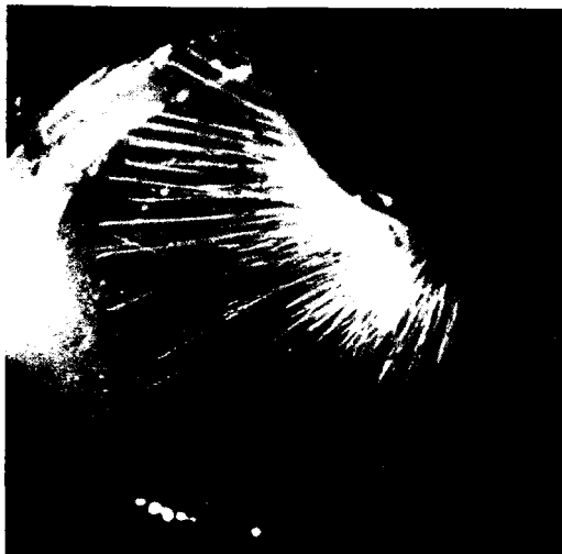
Abb. 15. Zertrümmerung von Bor ( {}_{5}\text{B}^{11} ) durch Protonen (Nach Kirchner)
