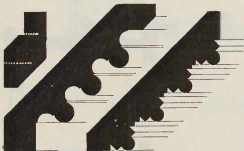
Fig. 33. Freistadt. Kirche. a) Sockelprofil. b) Gewände des Westportales und c) der Sakristeithür.
