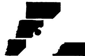
Abb. 231. Profile des Sakristei-Portals und des Sockelsteins der katholischen Pfarrkirche zu Mielenz. Maßstab 1:20.
